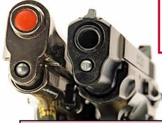
La trasformazione viene effettuata mediante una serie di operazioni, tra le quali, la più importante è quella della **sostituzione dell'originaria canna occlusa**, provvista di un focone per lo scarico dei gas dello sparo posto subito dopo e al di sopra della camera di scoppio (top firing), con un tubo metallico non rigato e, il più delle volte, leggermente sovracalibrato rispetto al diametro del proiettile utilizzato.
